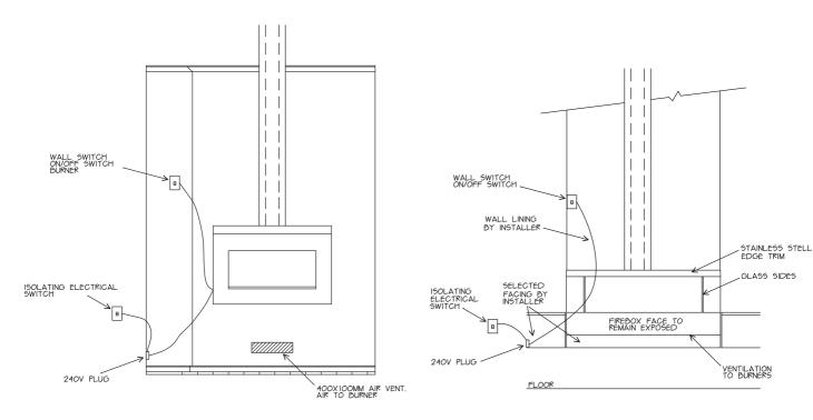
SINGLE SIDED ELEVATION CANTILEVER ELEVATION
